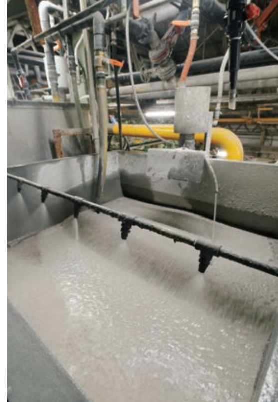
紙の原料がためられた種箱。濃度を一定にし、使用量を調整する
