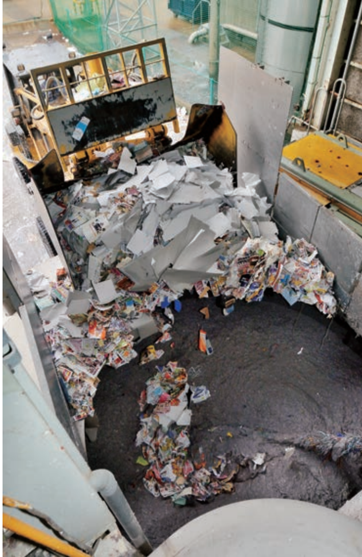
古紙原料を離解するバルバー。製造工程の第一歩となる
