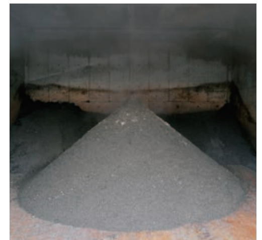
乾燥されたペーパースラッジ（乾燥汚泥）
