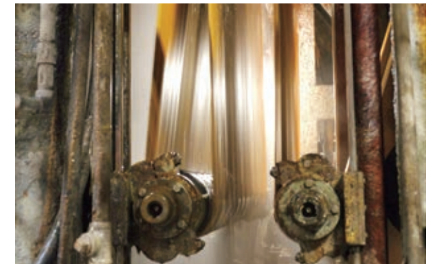
紙層を作るウェットパートで使われた毛布の洗浄。手厚い管理が上質の製品を生む
