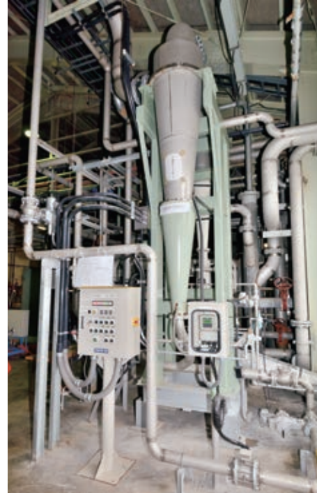
原料に含まれる砂や金属など重い異物を取り除くサイクロン
