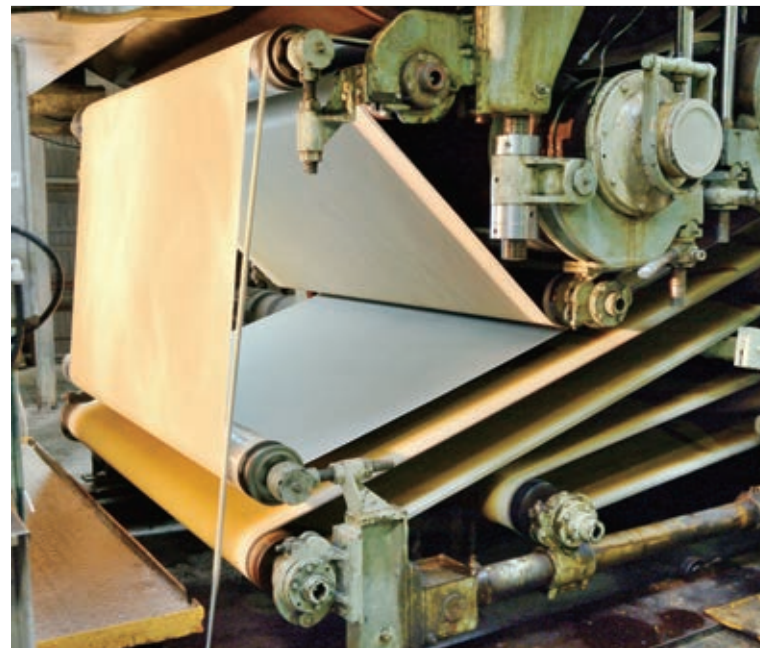
プレスパート(脱水装置)を経て、ヤンキードライヤー(乾燥機)に送り込まれる。紙の形が見え始める
